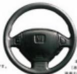
メーカーオプションのエアバッグ取付車には、必ずエアバッグシステム取付車とあるステアリングホイール(本車取付のAHMO規格)が装着されます。
