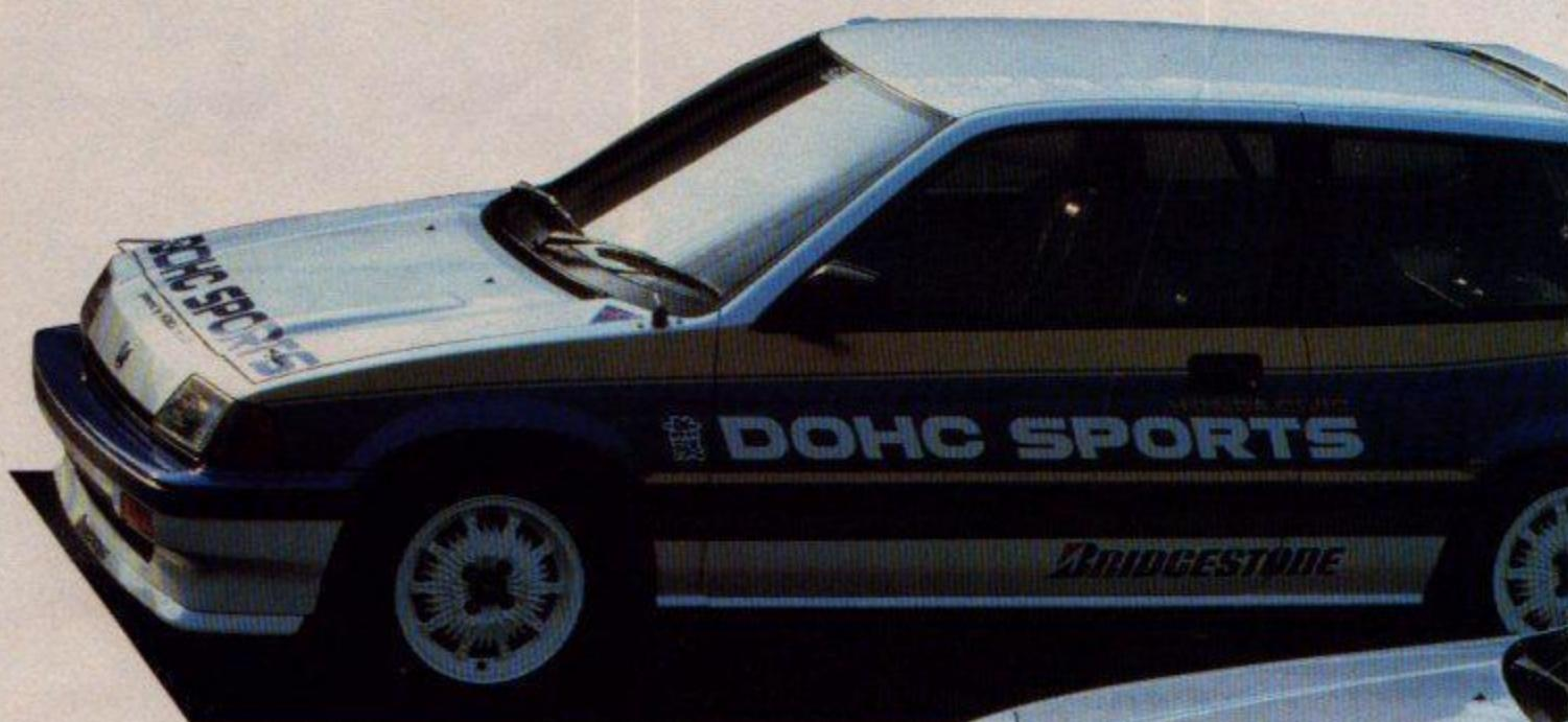
**バランスと専用設計**——時速100kmで走る車のホイールは、1秒間に約15回転する。ホイールが確実にセンターにセットされていなければ、ブレを起こしシミーを発生させる。汎用ホイールのスタッドボルトでセンターを決定する手法では1mm近いセンターワーストを起こすことがある。CF-48はホンダ車のセンターハブに合わせた、ホイールセンターホールを持っている。その2つを合わせてセットすることにより、常に確実にホイールはセンターにセットされる。
