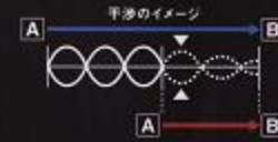
高音域はグラスワール、中低音域は「干渉」によって消音します。
