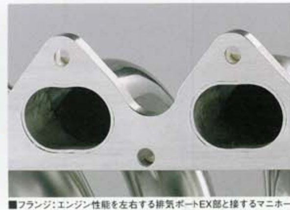
■フランジ: エンジン性能を左右する排気ポートEX部と接するマニホーマシニングフランジにパイプをインサート結合し、パイプ内面を研磨仕上げ
