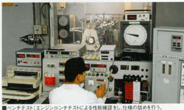
■ベンチテスト: エンジンベンチテストによる性能確認をし、仕様の詰めを行う。
