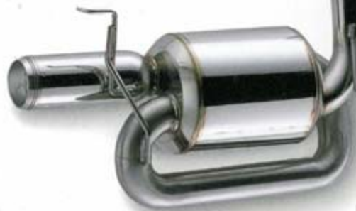
消音の「吸収」「干渉」という要素を積極活用する。パイプのループレイアウトとサイレンサー内のパイプのストレート化にこだわった内燃器構造。
