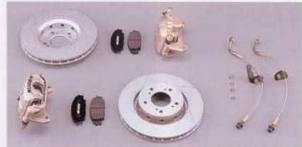
ティプゲート・ブレーキシステムでは、独特的のローター断面形状により冷却風を積極的にローター内部に取り込み、熱による変形を少なくすると同時にペダルタッチが良好に保てる向こへその変形をコントロールした新発想のブレーキシステムです。
