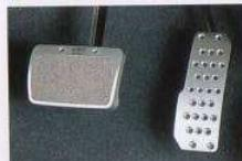
激しいアクセル＆クラッチワーク、ブレーキングをダイレクトに伝えるペダルキット。ペダルベースはアルミニウム製、クラッチ・ブレーキペダルのストッパー部にニッケルクロームベースの発光金属を採用しました。MT・AT各車種用。
