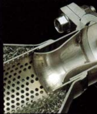
コントロールベンチュリーが排圧の上昇なしに、コントロールします。
