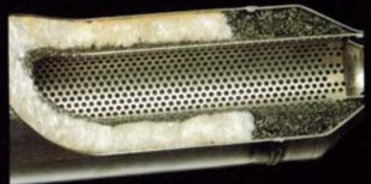
ステンレスメッシュスリーブとステンレスワール2重巻により、グラスウールのふきぬけを防ぎます。
