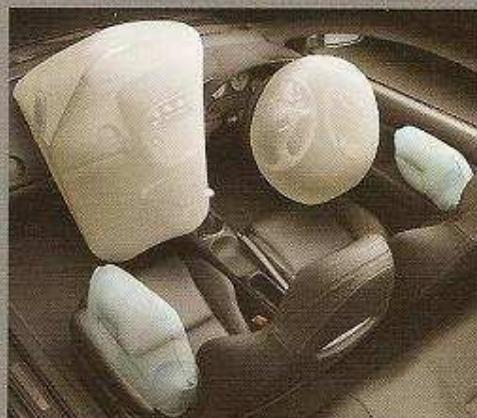
安全なTYPE-S。横衝突防護のため、運転席用及助手席用SRSエアバッグシステム。前常用・サイドエアバッグシステムにも同時にいた状態を維持します。
