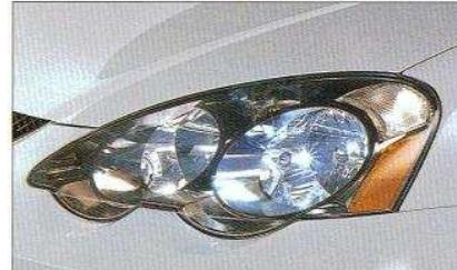
ハロゲンの約2倍の光量を持つディスチャージヘッドライト（ロービーム）を採用。配光特性に優れたマルチリフレクターとともに、良好な視認性を実現する。また、急制動時の車輪ロックを防ぐABSも全車に標準装備している。
