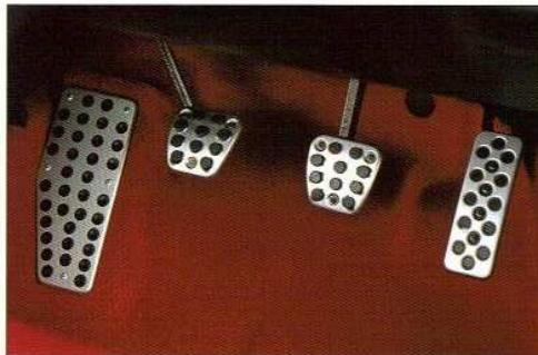
手もとに直立するクロスレシオ6速MTのシフトノブ、そして、ヒール&トゥのしやすさを徹底追求した各ペダルのパッドと運転席フットレストにアルミを採用。TYPE Rならではのスポーツテイストを際立たせるとともに、軽量化を図っている。また、シフトブーツに走る赤ステッチや、アルミを採用したサイドブレーキノブもTYPE R専用仕様だ。インテリアカラーのレッド、ブラックに採用。
