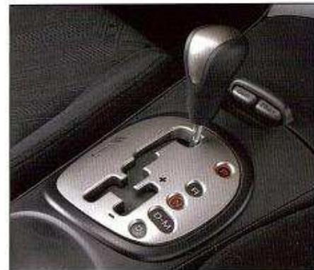
ATは、1~5速をシーケンシャルに選択できるMモードを備えた5速AT Sマチックを採用。ワインディングでの俊敏なスポーティ走行など、2.0ℓDOHC i-VTECパワーを自在に使いこなす楽しさが満喫できる。雪道などの滑らかな発進を可能にする2速ホールドモードも搭載した。また、iSに最適化したHonda独自の変速スケジュールシステム「プロスマティック」が、走行状況に応じて知的シフト制御を行い、登・降坂時のスムーズな走りをサポート。さらに、走りの楽しさと経済性をハイバランスさせたギアレシオ設定に加え、燃費特性を高めるアクティブ・ロックアップ<sup>11</sup>を採用し、スムーズな走行性と優れた経済性を両立している。TYPE Rの6速MTと同一の基本骨格を持つ軽量コンパクトな5速MTは、1~2速にトリプルローン、3~4~5速に大容量のシンクロを採用してシフト荷重を大幅に低減、極めて軽快なシフトフィールを提供する。
