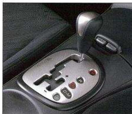
ATは、1～5速をシークンシャルに選択できるMモードを備えた5速AT Sマチックを採用。ワインディングでの俊敏なスポーティ走行など、2.0ℓDOHC i-VTECパワーを自在に使いこなす楽しさが満喫できる。雷道などでの滑らかな発進を可能にする2速ホールドモードも搭載した。また、iSに最適化したHonda独自の变速スケジュールシステム「プロスマチック」が、走行状況に応じて知的シフト制御を行い、登・降坂時のスムーズな走りをサポート。さらに、走りの楽しさと経済性をハイバランスさせたギアレシオ設定に加え、燃費特性を高めるアクティブ・ロックアップⅡを採用し、スムーズな走行性と優れた経済性を両立している。TYPE Rの6速MTと同一の基本骨格を持つ軽量コンパクトな5速MTは、1・2速にトリプルコーン、3・4・5速に大容量のシンクロを採用してシフト荷重を大幅に低減、極めて軽快なシフトフィールを提供する。
